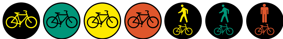
Obr. Svetelné signalizačné zariadenia súvisiace s cyklistickou dopravou
